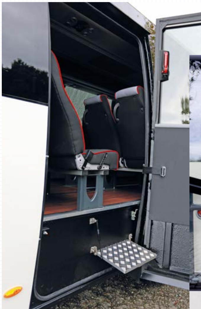
Puerta de emergencia con escalera
